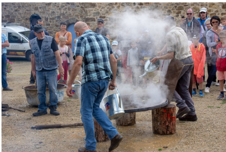
Positionnement et refroidissement du cercle
