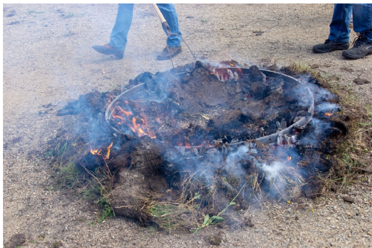
Cerclage de roues 18.08.2019 : la chauffe du cercle
