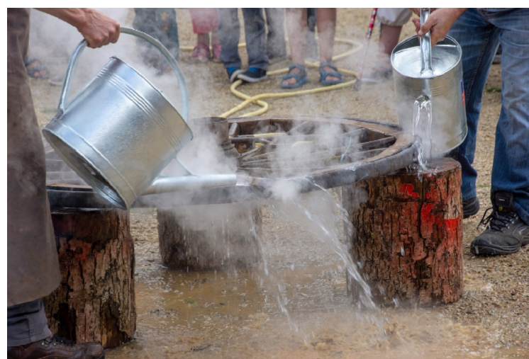
Positionnement et refroidissement du cercle
